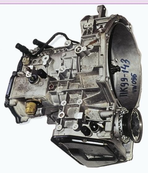
Согласитесь, эта АКПП автомобиля VW, с точки зрения компактности даст сто очков вперед «классике» с планетарным рядом Симпсона. Планетарный механизм занимает чрезвычайно мало места. Остальной объем редуктора «заполнен» сцеплениями и тормозами.
