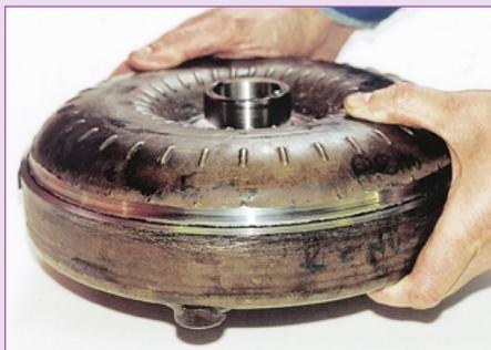
ГДТ в коробке, выполненной по двухпоточной схеме, на удивление плоский. Внутри него можно увидеть все те же три колеса, но вместо блокировочного сцепления — лишь демпфер крутильных колебаний.
