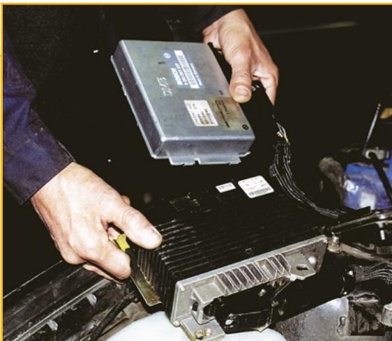
У автомобилей *BMW* компьютер АКПП представляет собой отдельный блок, по размерам превосходящий компьютер системы управления двигателем.
