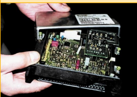
«Внутренности» блока управления АКПП автомобиля *Audi* выглядят традиционно: хитросплетение радиокомпонентов и микросхем. Ни тестер, ни осциллограф не помогут разобраться в его загадках.
