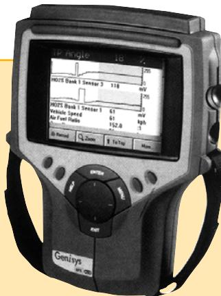
Новейшая разработка фирмы OTC — сканер **Genisys**, предназначенный для углубленной диагностики американских автомобилей и других, поддерживающих протокол **OBD II**. Имеется возможность вывода на цветной дисплей графиков изменения текущих параметров коробки в динамическом режиме. Стоимость в полной комплектации — 3 700 долларов.
