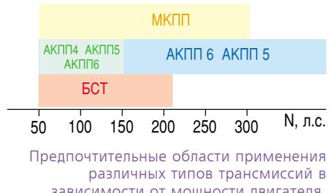
Предпочтительные области применения различных типов трансмиссий в зависимости от мощности двигателя.
