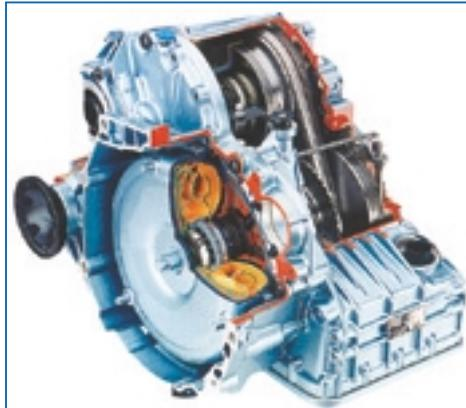
В конструкции БСТ Ecotronic, предназначенных для передачи больших крутящих моментов, в качестве приводного устройства используется гидротрансформатор. Это повышает плавность трогания с места и проходимость автомобиля, уменьшает динамические нагрузки на вариатор.
