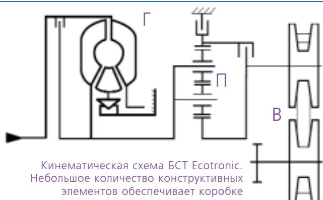
Кинематическая схема БСТ Ecotronic. Небольшое количество конструктивных элементов обеспечивает коробке компактность.
