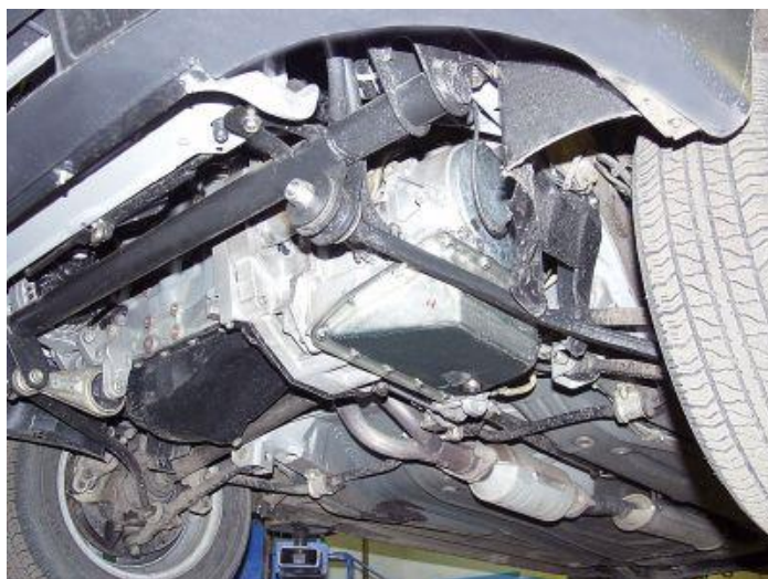
Вариатор установлен на месте стандартной механической трансмиссии через специальную проставку
