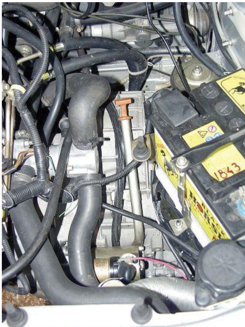
Под капотом вариаторной машины - еще один маслоизмерительный щуп
