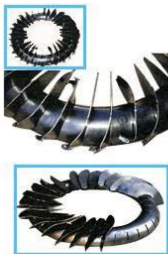
Фото 4. Этапы разрушения лопастей насосного колеса.
