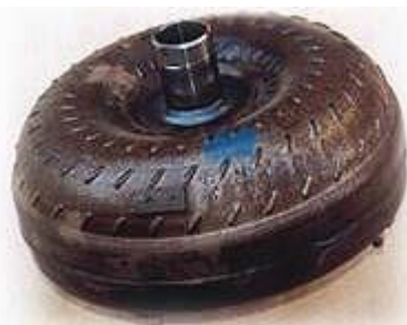
Фото 1. Внешний вид гидротрансформатора.
