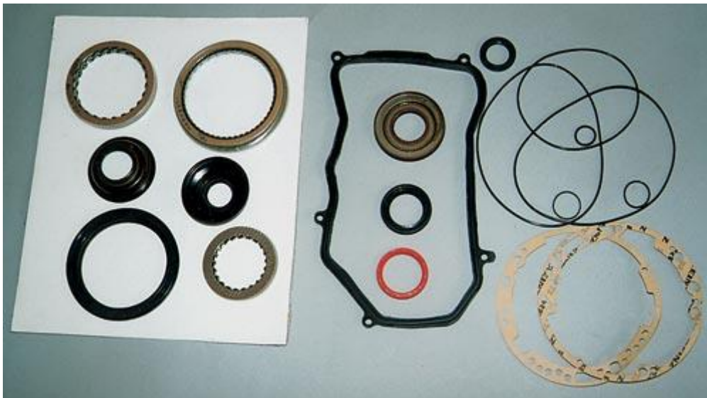
Минимальный ремкомплект включает лишь сальники и прокладки
