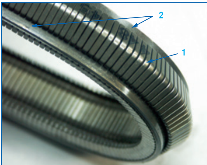
Толкающий ремень сформирован из стальных пластин трапецевидной формы (1), прочно стянутых в замкнутый пакет двумя многослойными металлическими лентами (2).
