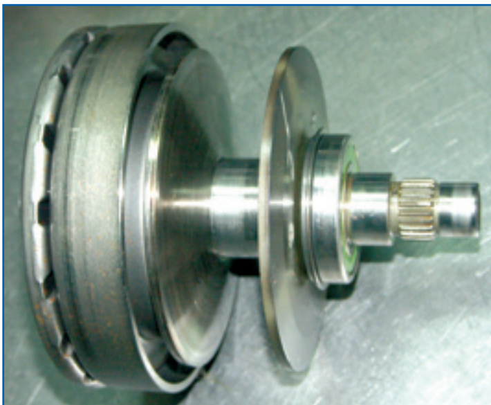
Шкив вариатора состоит из двух конических дисков. Тот, что слева — подвижный, его положение регулируется гидроцилиндром.
