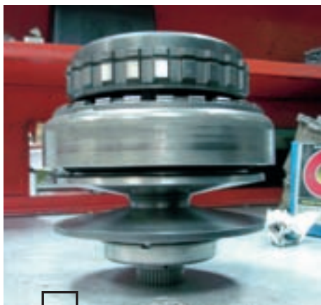
Шкив вариатора. На данный момент в российском автопарке вариаторов на порядок меньше, чем гидравлических «автоматов».
