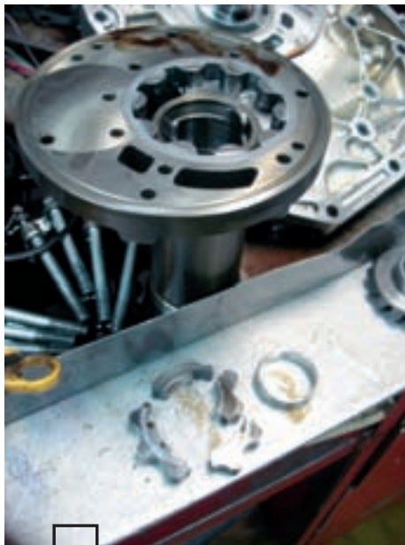
Развалившийся маслонасос. Возможно, дефектная партия.
