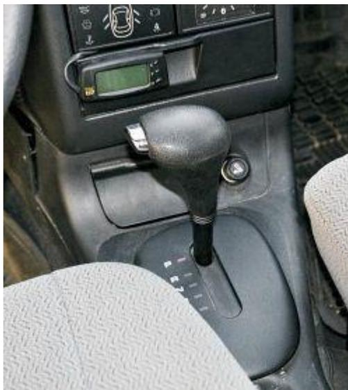
*Место рычага механической коробки передач занял селектор вариатора*
