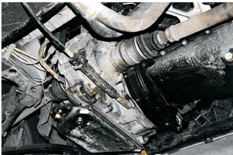
*Шестнадцатиклапанный двигатель ВАЗ-2112 и бесступенчатая коробка передач VT1*
