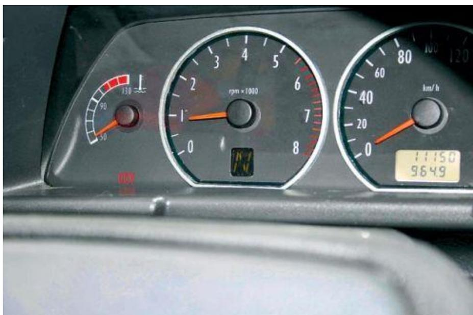
*Включенная передача проецируется на окошко в тахометре*
