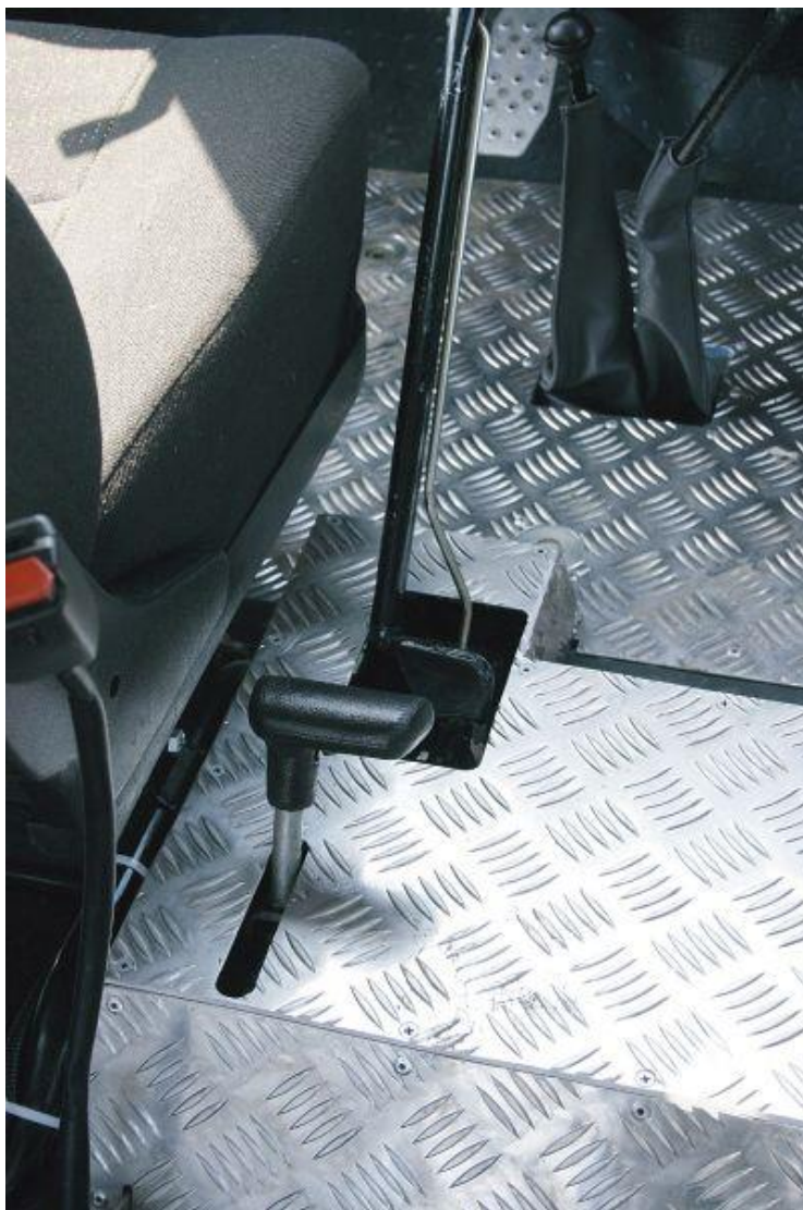
Селектор управления автоматической коробкой передач установлен справа, за сиденьем водителя. Индикатор включенного диапазона «имплантирован» в комбинацию приборов
