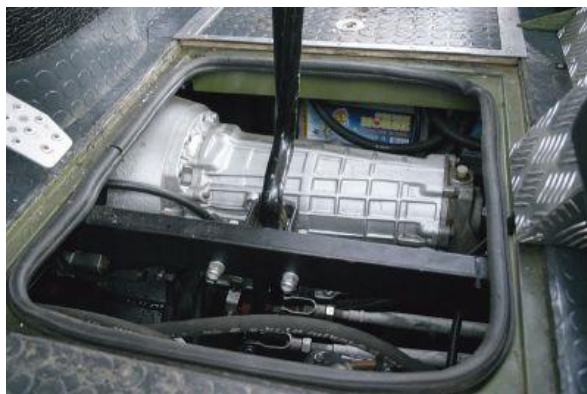
Доступ к коробке передач осуществляется через люк, расположенный под ногами водителя
