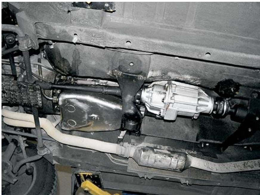
Новая трансмиссия подошла к "Ниве" с минимальными переделками
